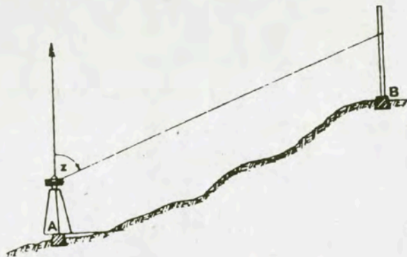
Σχ.25 Τομή του εδάφους με κατακόρυφο επίπεδο όπου φαίνεται η ζενίθια γωνία.
