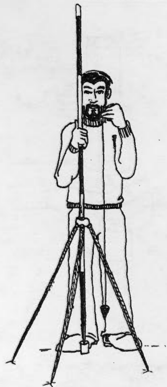
Κατακορύφωση ακοντίου με τη βοήθεια νήματος της στάθμης
